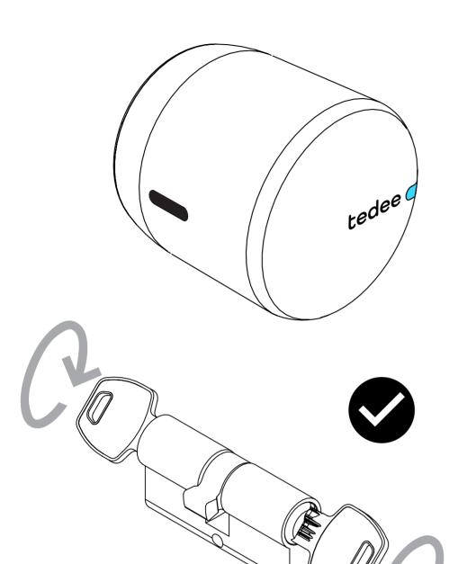
Tedee GO ist ein smartes Türschloss, das an einem beliebigen Euro-Profilzylinder angebracht werden kann, der über eine Not- und Gefahrenfunktion verfügt.
