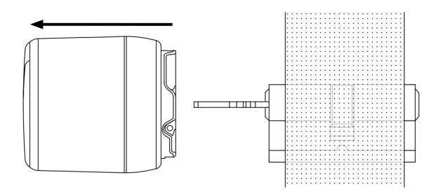
Erwärmen Sie den Adapter für etwa 10-15 Minuten mit einem Haartrockner und versuchen Sie, ihn mit einem Schlitzschraubenzieher vorsichtig zu lösen. Sollte dies nicht gelingen, wiederholen Sie den Vorgang, bis sich der Adapter von der Tür lösen lässt.
